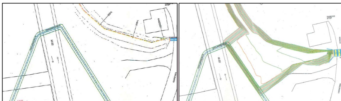
Ilustración 3. Vista en planta del cauce del arroyo Rejas en el entorno de actuación en la situación preoperacional (izquierda) y postoperacional (derecha). Fuente: Documentación aportada.
