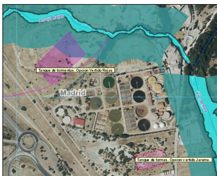
Ilustración 11. Actuaciones solicitadas (tanques de tormenta) respecto al dominio público hidráulico probable, zonas de servidumbre y policía del arroyo Rejas y río Jarama. Fuente: Visor SIT Tajo.
